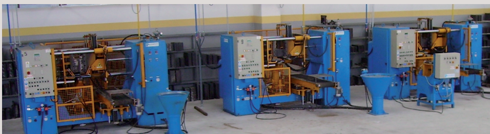
Serie macchine sparaanime per shell moulding installate presso Animisteria Duso Srl - Sarcedo (Vi).
