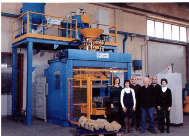
Spara-anime per cold box da 60 litri con impianto di preparazione sabbia. In primo piano lo staff direzionale
