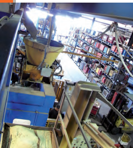
Fig. 3 La miscela viene scaricata nella tramoggia, che qui alimenta una macchina spara anime da 50 kg.
