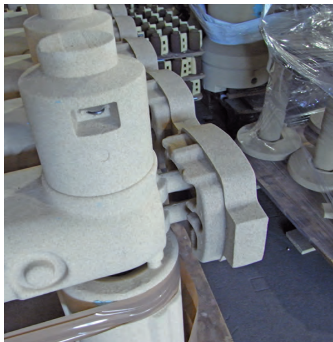
Fig. 5 Le anime vengono formate secondo vere e proprie "ricette" messe a punto dalla fonderia Palmieri con l'esperienza, la conoscenza, le prove, il tempo.
