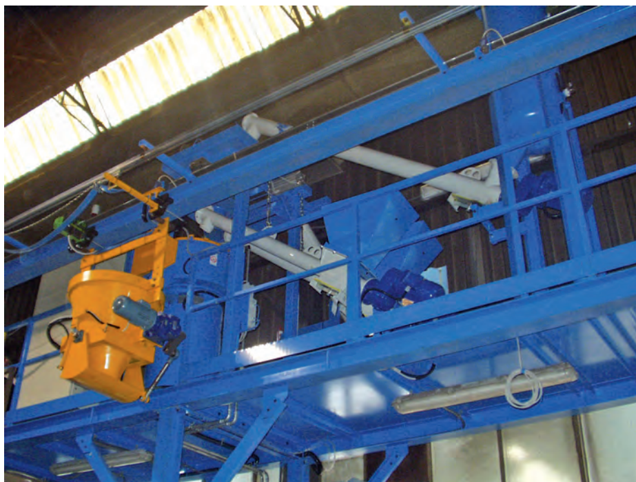
Fig. 2 Nel mescolatore sopra il soppalco avviene il dosaggio degli ingredienti (sabbia e additivi).
