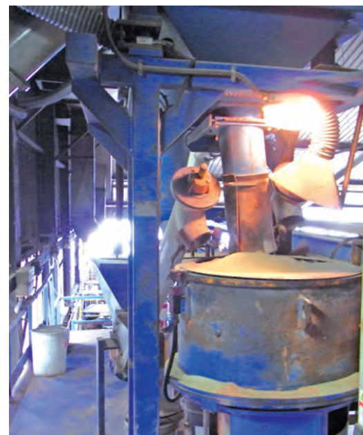
Fig. 2 Nel mescolatore sopra il soppalco avviene il dosaggio degli ingredienti (sabbia e additivi).
