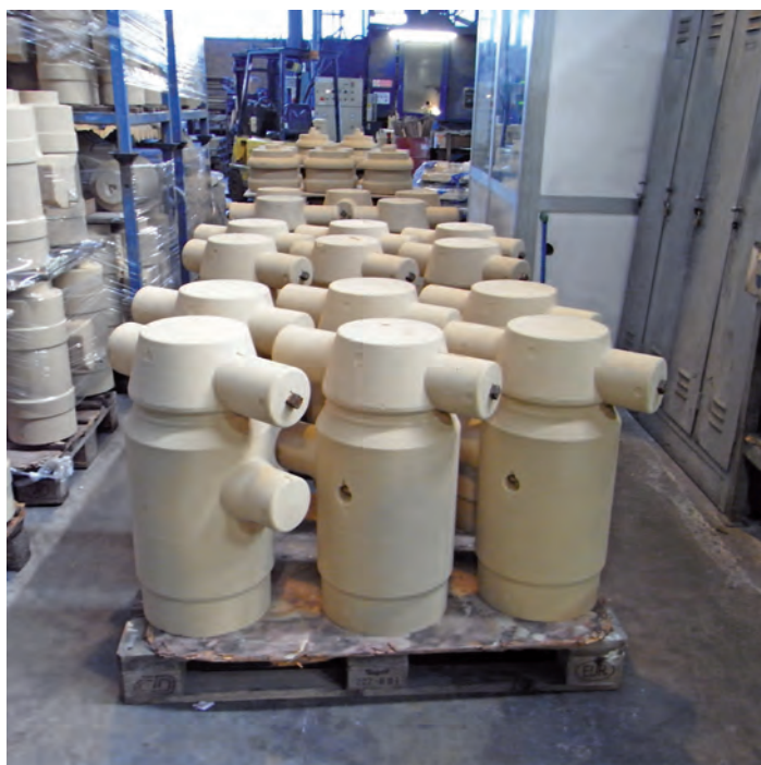
Fig. 5 Le anime vengono formate secondo vere e proprie "ricette" messe a punto dalla fonderia Palmieri con l'esperienza, la conoscenza, le prove, il tempo.
