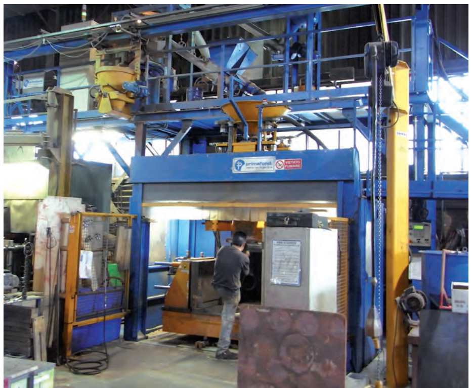
Fig. 1 Il dosaggio e la miscelazione delle materie prime per formare le anime, le quantità delle miscele, nonché l'alimentazione alle varie macchine spara anime, vengono eseguite nelle Fonderie Palmieri con un sistema del tutto automatico.
