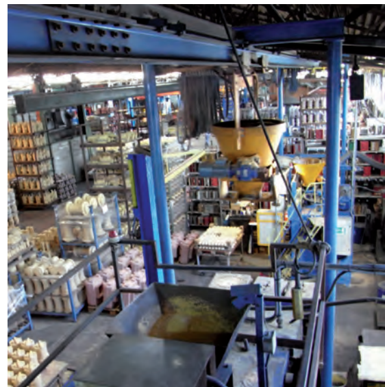
Fig. 4 Il carrello con la miscela si avvia in un'altra zona dello stabilimento per alimentare altre macchine spara anime.
