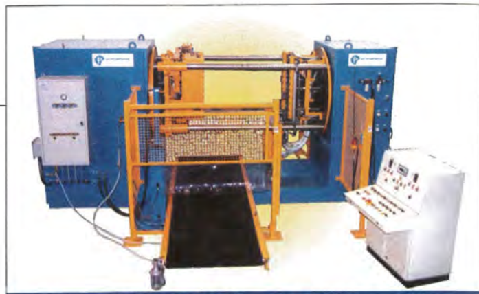
Macchina Sparaanime per Shell Moulding modello SMEC 70 rovesciabile.
