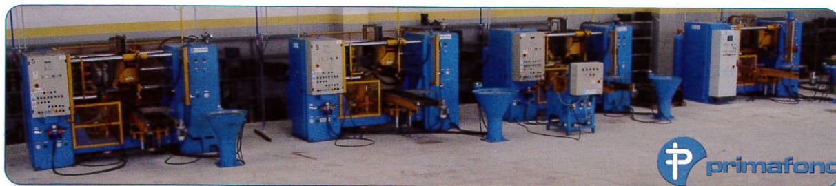
Serie macchine sparaanime per shell moulding installate presso Animisteria Duso Srl - Sarcedo (Vi).
